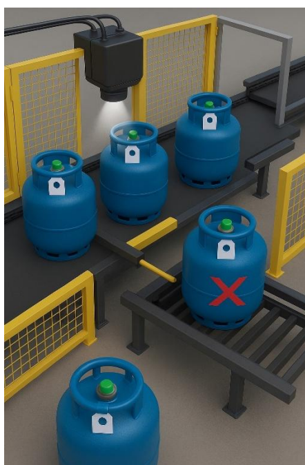
Figura 3: representação do sistema de visão para detecção automática de desvios em lacres e etiquetas.
