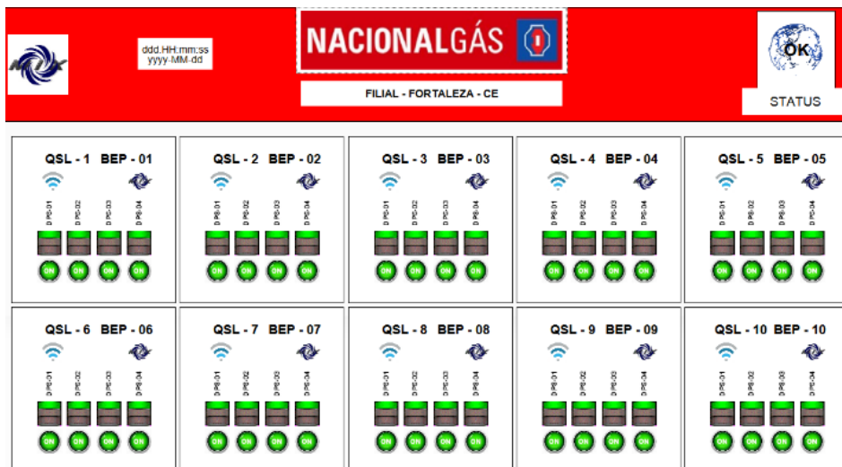
Figura 13: Painel de funcionamento geral dos DPS.
