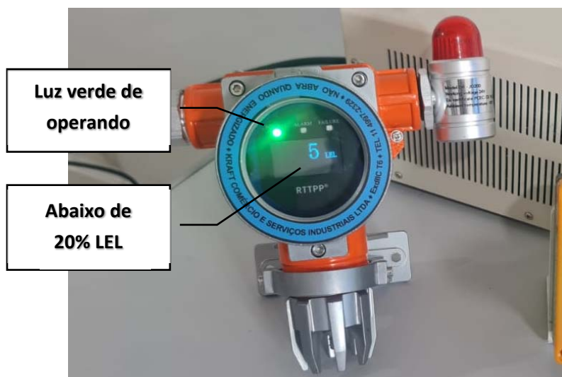
Figura 8 - Detector de Gás Ex em funcionamento normal (laboratório)
