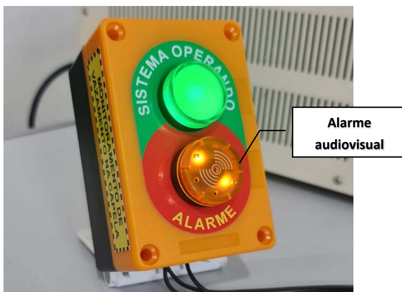
Figura 12 - Dispositivo de sinalização teste de alarme (laboratório) Fonte: KRAFT COMÉRCIO E SERVIÇOS INDUSTRIAIS LTDA, 2025
