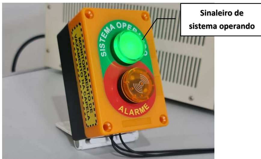
Figura 11 - Dispositivo de sinalização teste em funcionamento normal (laboratório) Fonte: KRAFT COMÉRCIO E SERVIÇOS INDUSTRIAIS LTDA, 2025
