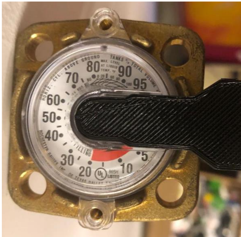
Figura 6 – Case do sensor em PLA simples em teste de acoplamento
