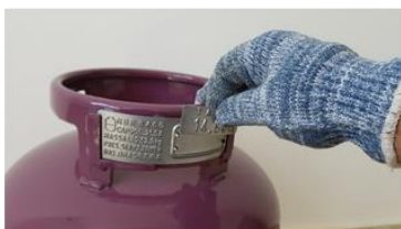
A abertura das garras permite a inserção de uma nova plaqueta de tara.
