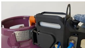
Acionamento do botão pneumático para o fechamento das garras da PI.
