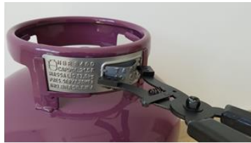
Posicionamento do alicate extrator entre a plaqueta de tara e o debrum
