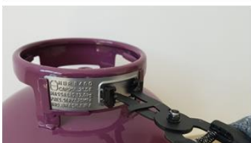
Abertura das garras da PI com o alicate de calibrador de garras.
