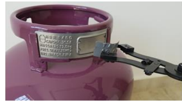
Retirada da plaqueta de tara feita através do alicate de extrator
