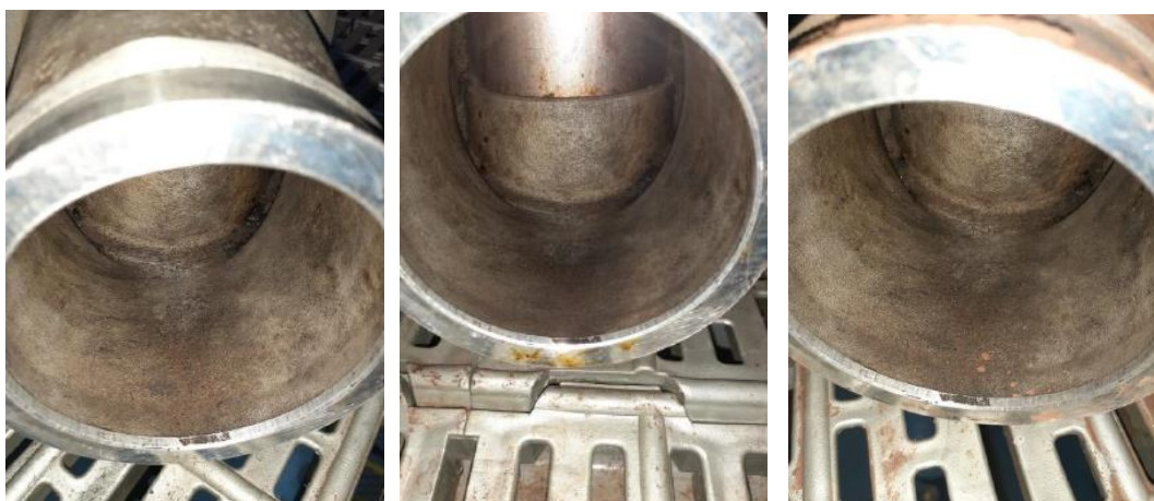
Figura 12: Registro fotográfico no intervalo de 29 dias do queimador com filtro coalescente..
