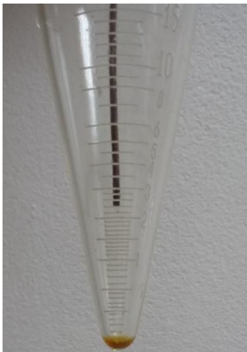
Figura 8: Resultado teste de resíduo em 100ml evaporados.
