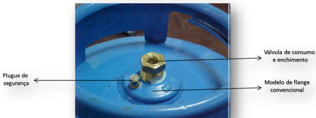
Figura 2 – Sistema de flange com válvula e plugue fusível montado.
