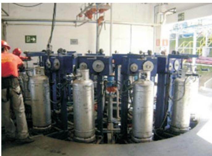
**Figura 16: Detalhe do envasamento de botijões P-20, P-45 e P-90**
