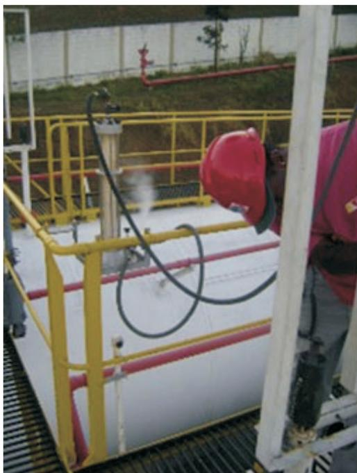
**Figura 06:** Emissão de GÁS LP no processo de medição com termodensímetro
