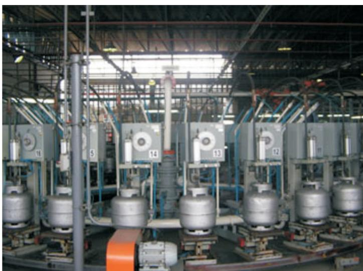
**Figura 13: Detalhe do envasamento de botijões**
