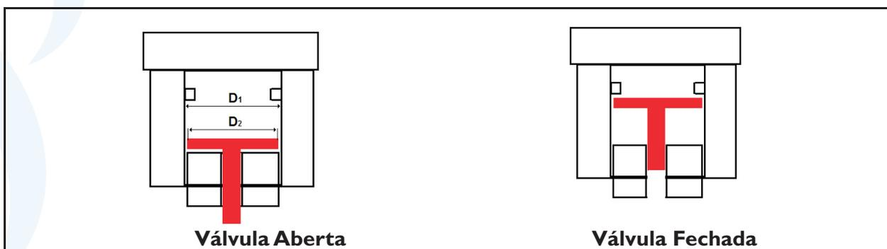
Figura 14: Detalhe de Funcionamento da Válvula Automática
