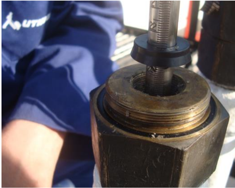
Foto : Colocação do Anel de Vedação
