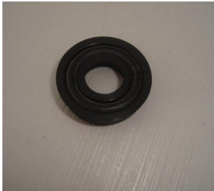
Foto 12: Anel de Vedação – Gaxeta UA-1 (lado b)
