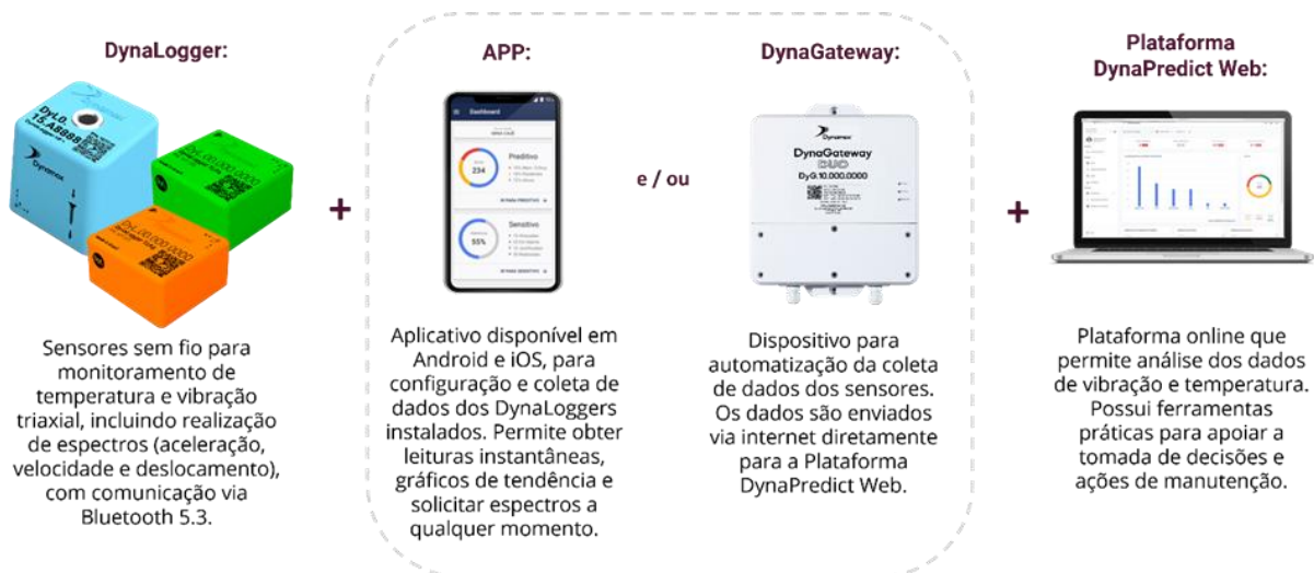
Figura 6: Ilustração dos componentes do sistema de coleta e monitoramento de vibração e temperatura. Fonte: Dynamox
