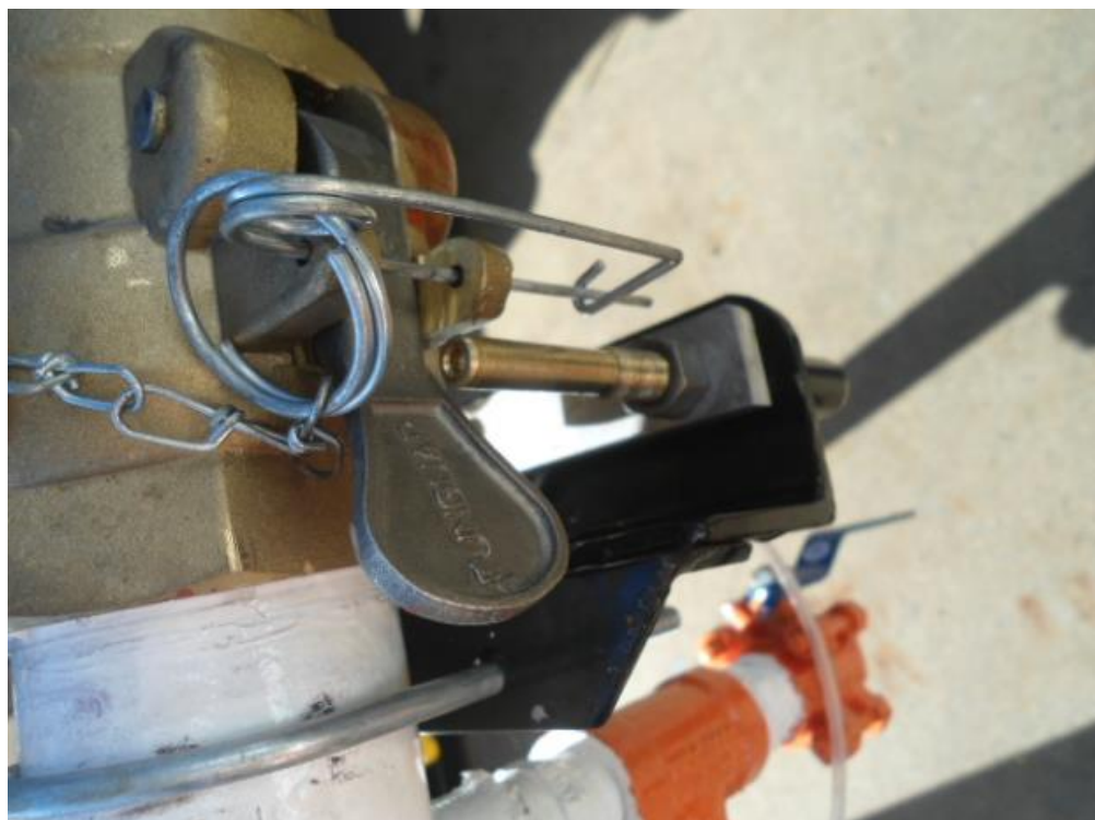
Figura 9 – Detalhe do Pino Trava para acoplador de mangote de GLP.
