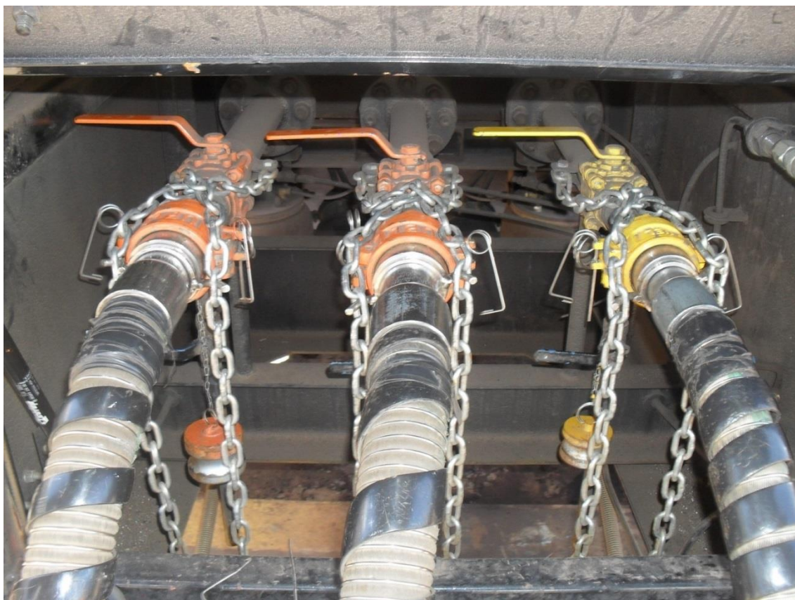
Figura 3 – Trava manual do acoplador de mangotes / pinos / correntes.
