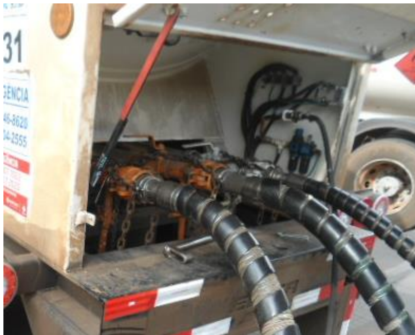
Figura 2 – Capela de caminhão auto tanque, mangotes de GLP e sistema de ar comprimido.
