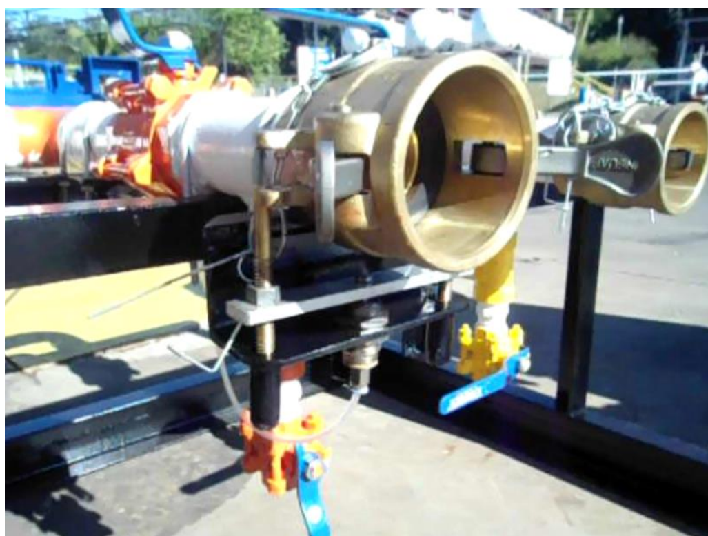
Figura 5 – Acoplador para Mangote de GLP com Kit- trava desenvolvido.
