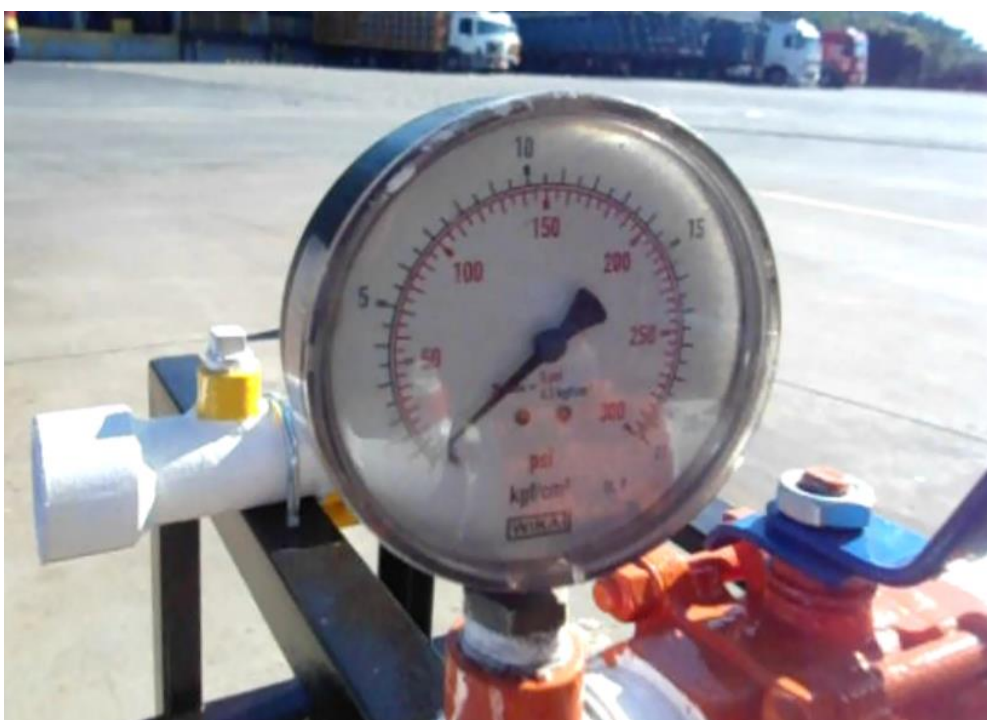
Figura 13 - Detalhe do sistema despressurizado.
