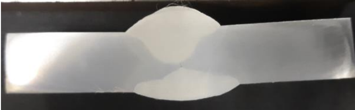
Figura 8: Ensaio macrográfico realizado em um dos corpos de prova.
