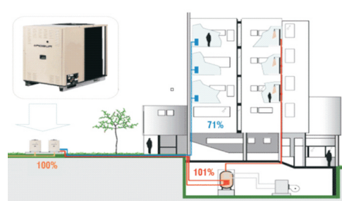
Figura 4 - Cogeração de energia ciclo de absorção geração de frio e calor
