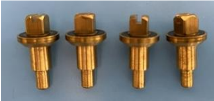
Figura 04 Porta Vedação montado com arruela e parafuso quadrado
