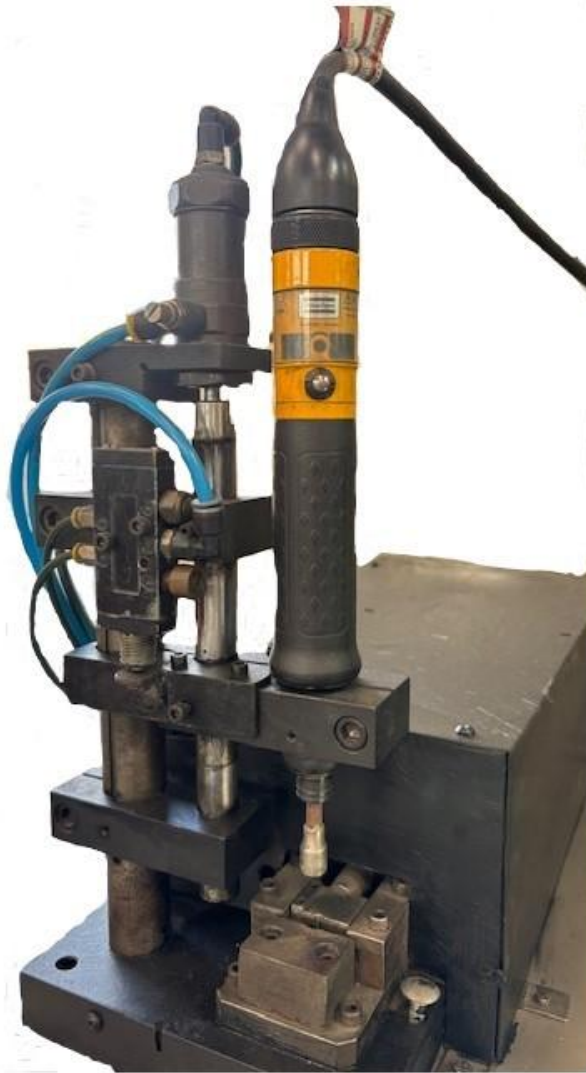
Figura 02 Apertadeira montada no dispositivo
