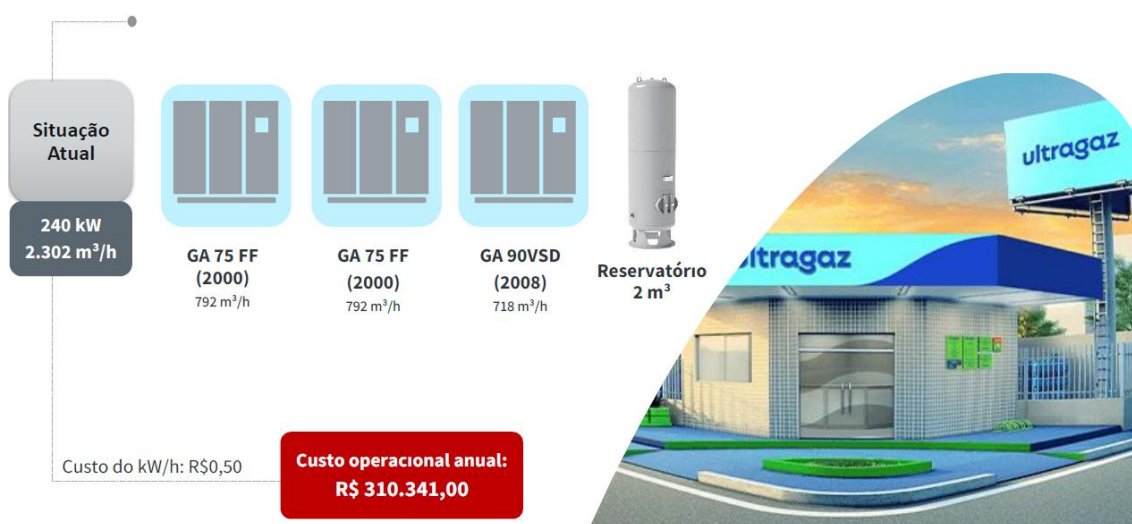
Figura 2: Situação atuação - sala de compressores Base de Araucária.
