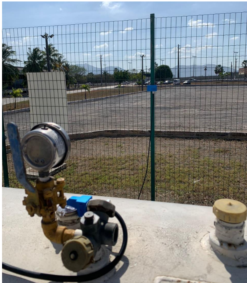
Figura 16 – Vista em campo do sensor acoplado e da caixa de dados Y fixada na central
