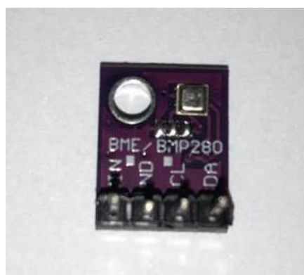
Figura 15 – Vista lado A e lado B do sensor múltiplo BME280 num shield HW
