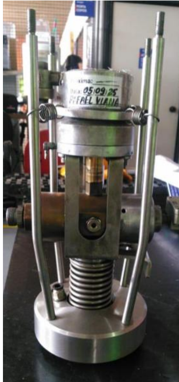
Figura 04 – Cabeça de enchimento desmontada
