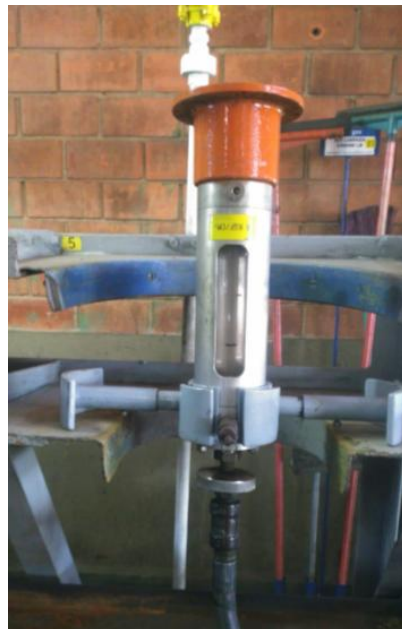
Figura 07 – Dispositivo coletor de nevoa na decantação.
