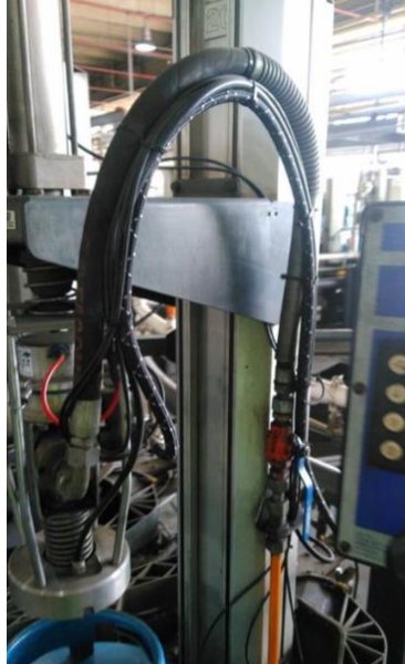
Figura 03 – Mangueira de alimentação de GLP e Válvula esfera.
