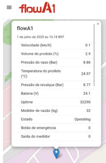
Figura 6: Visualização da localização e parâmetros do caminhão no aplicativo em tempo real
