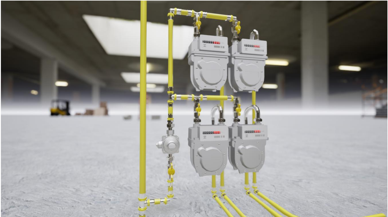
Imagem 13 - Montagem de Abrigo de Medidores com o 516 DSA/OPSO em BIM com renderização foto-realista
