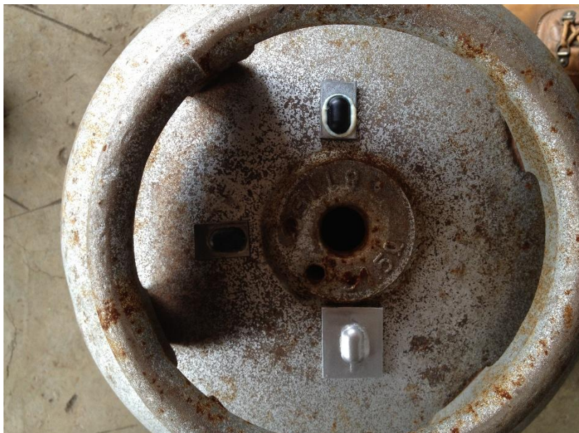
POSICIONAMENTO DOS TRANSPONDERS AO REDOR DA FLANGE DO VASILHAME
