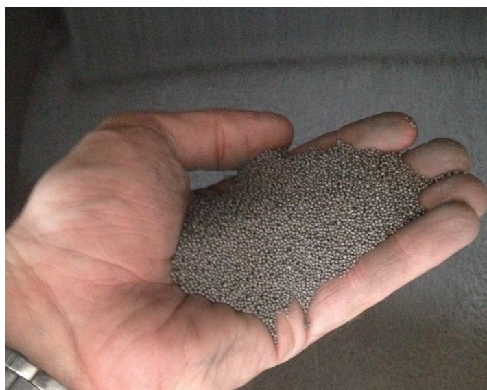
GRANALHA DE AÇO UTILIZADA NO PROCESSO DE DECAPAGEM MECÂNICA
