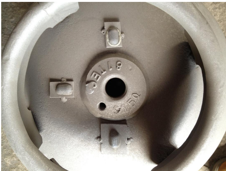
TRANSPONDERS APÓS QUINTA PASSAGEM PELO PROCESSO DE DECAPAGEM MECÂNICA
