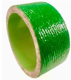
Figura 9 - Trecho de tubulação com aplicação de revestimentos convencionais por sistemas compósitos com Tecido Biaxial 1808 e resina epóxi de alta performance
