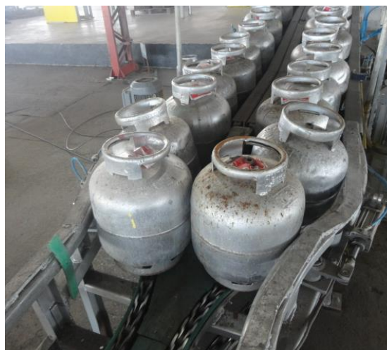
Figura 3 - Gargalo causado falta de sincronia entre transportadores
