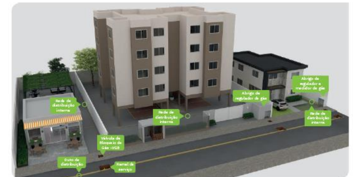
Figura 02 - Abastecimento de Gás Natural
